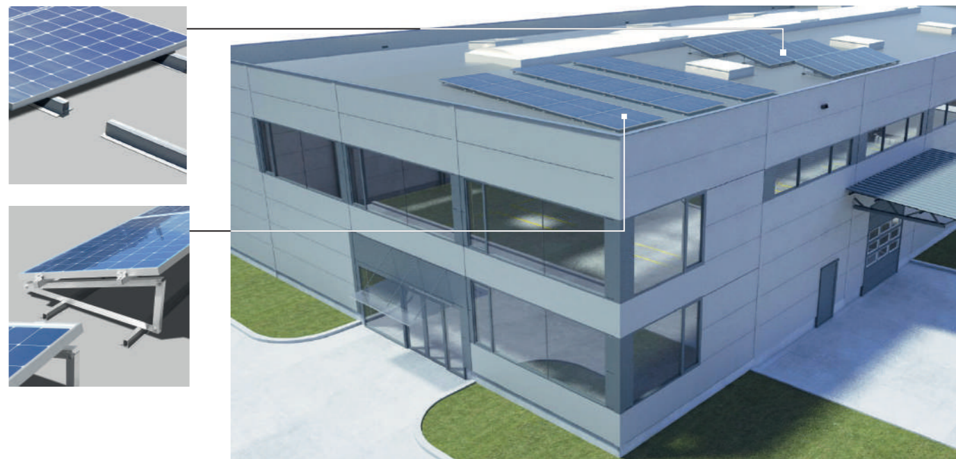
FOTOVOLTAICKÉ PANELE NA FOLIOVÉ STŘEŠE
